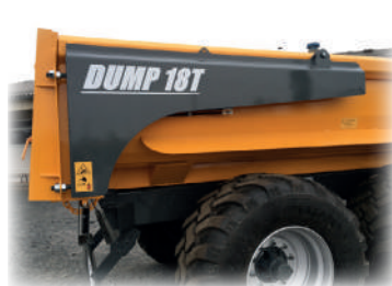
Bras avec clapet de sécurité sur vérin de porte
