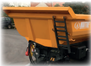
Casquette avant encastrée et échelle d'accès repliable
